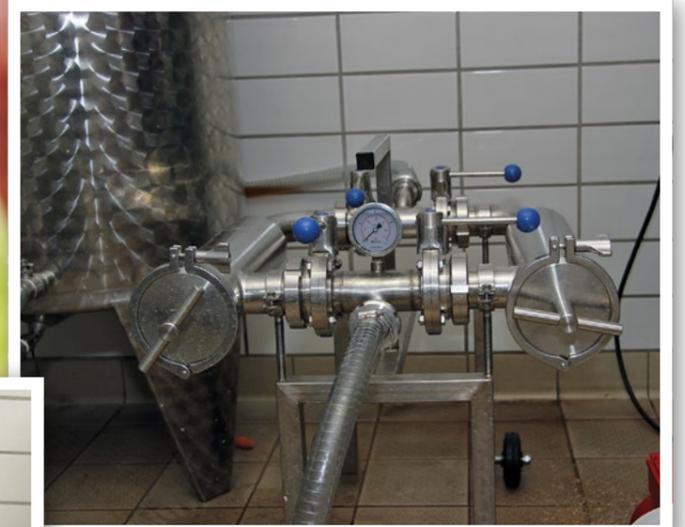
Der Spaltrohrfilter zum Filtern des Saftes
