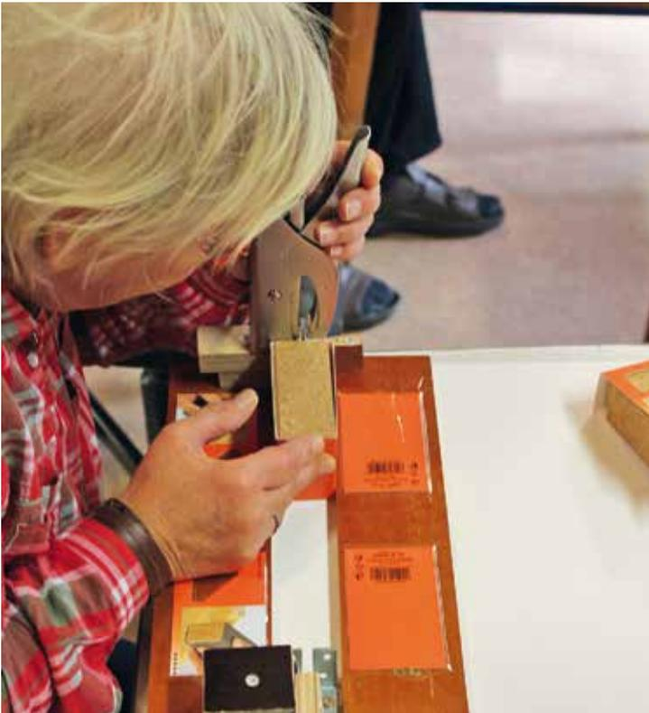
**Schritt 4:** In Schritt 4 werden beide oberen Seiten der Manschette mit einem Tacker zusammen geklammert. Für diesen Arbeitsschritt kommen auch wieder Hilfsmittel zum Einsatz, die auch extra entworfen und von den Mitarbeitern hergestellt wurden.
