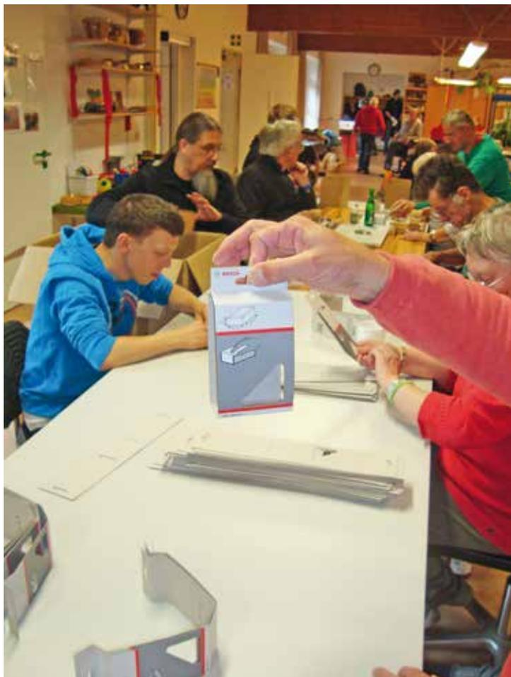
**Schritt 1:** Dort müssen die Kartons gefaltet werden, in denen am Ende die Schleifklötze eingepackt werden. Diese werden von zwei Beschäftigten per Hand fertig gefaltet.
